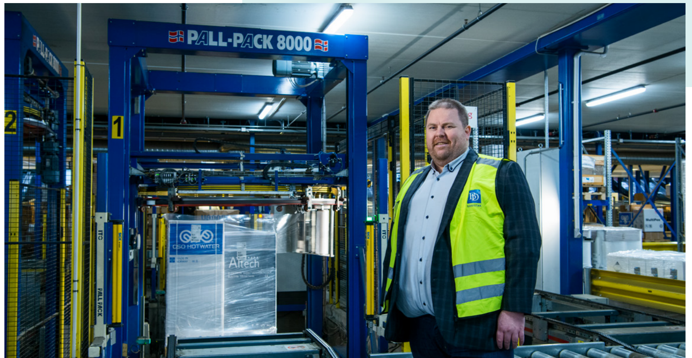
-Denne palleplastmaskinen pakker inn pallene med "grønn" plastfilm, forteller produksjonssjef Thomas Bjerkseter.
